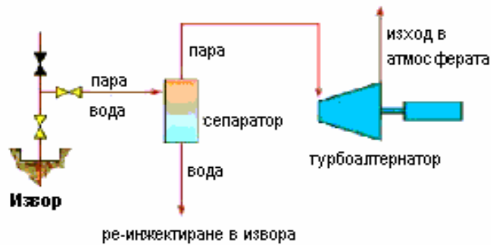
Геотермална централа за производство на електрическа енергия с ре - инжекция, атмосферен тип
